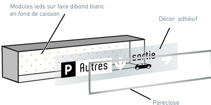
➤ Schéma détaillé d'un caisson profilé joints creux
